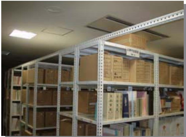
図書室の棚の連結固定を実施することで、地震発生時の転倒を防止する。
